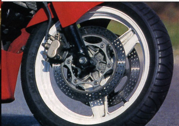
Discos de 296 mm y pinzas de 2 pistones paralelos le daban una excelente frenada a la VFR 750 F.
